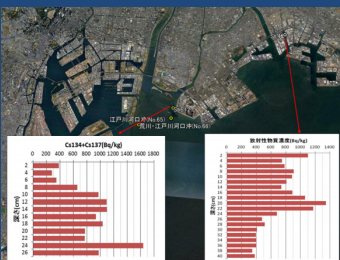
Figure2. 真間川河口前面海域および江戸川河口の鉛直方向の堆積分布 (本研究調査結果)
