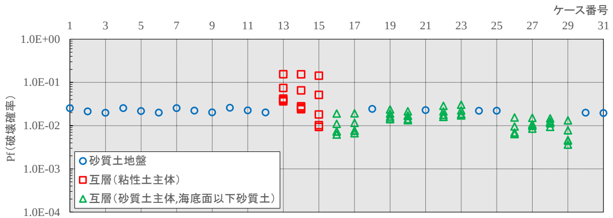
図-4.5 矢板壁の根入れ長に関する各ケースの破壊確率(全ケース)
