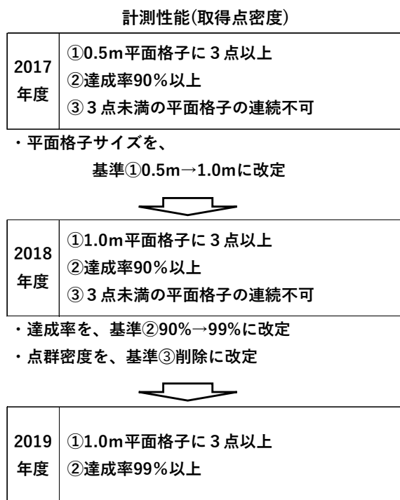
図-3.4 計測性能（取得点密度）の改定 20~21)
