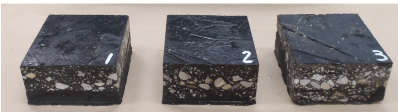
摩擦試験用供試体(150×150×50 mm 捨石側の凹凸を成型)
