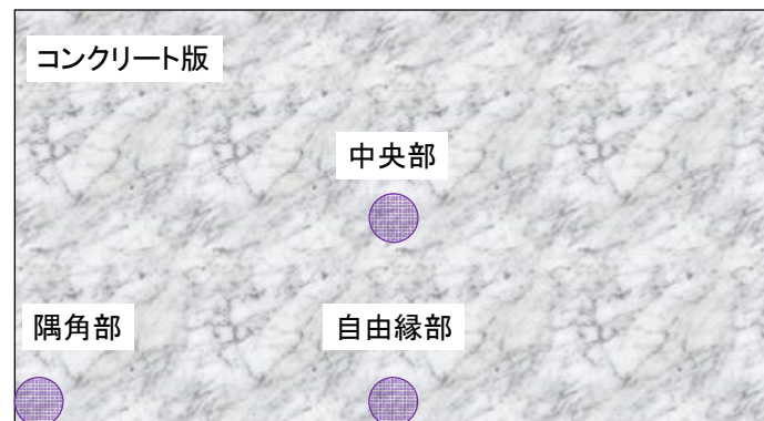
図-1.1 コンクリート版における載荷位置の平面図
