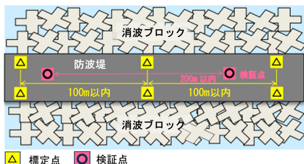
図-2.4 標定点・検証点の設置イメージ(消波工) 10)
