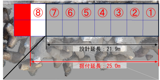
図-4.8 格子法出来形：格子サイズB/n（金沢港 UAV 写真測量）
